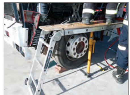
Imagen 323. Colocación de escalera articulable con refuerzo de puntal y asegurada con ratchet
