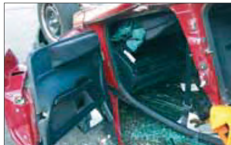
Imagen 230. Retirada de la puerta
