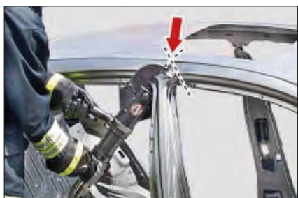
Imagen 253. Corte del montante B con refuerzos estructurales
