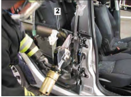
Imagen 311. Corte del marco de cristal. (2) Marco de cristal
