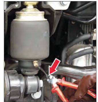
Imagen 321. Lugar de corte de la tubería de aire del fuelle neumático
