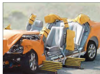
Imagen 257. Protección de aristas de corte
