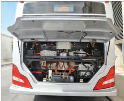
Imagen 123. Ejemplo de Baterías en autobuses
