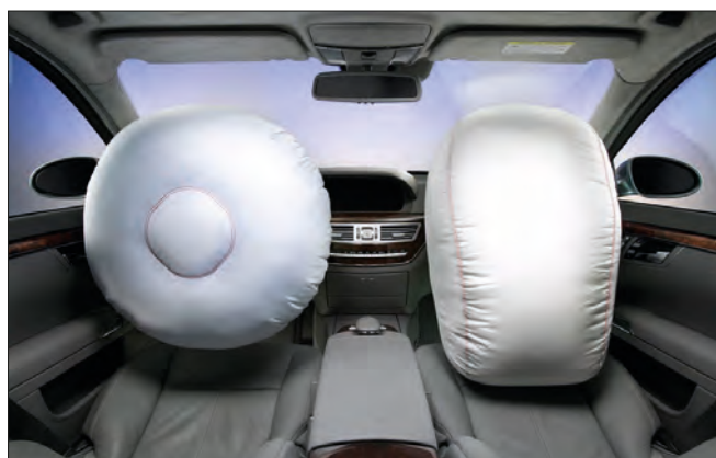
Imagen 86. Vehículo con los airbags activados
