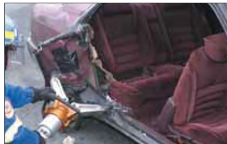
Imagen 224. Paso final en la apertura de la tercera puerta
