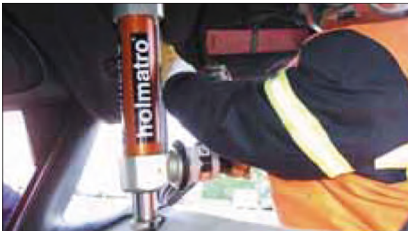
Imagen 277. Colocación de cilindro de separación
