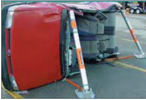
Imagen 153. Estabilización del techo
