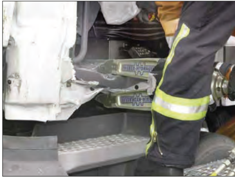
Imagen 337. Aplastamiento del umbral
