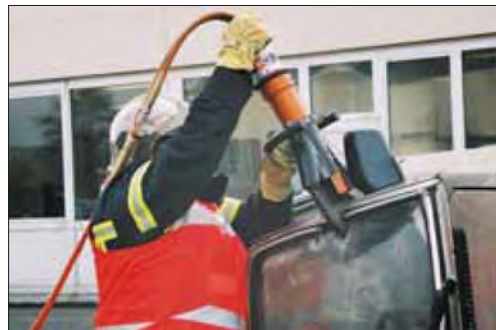
Imagen 268. Corte del montante A
