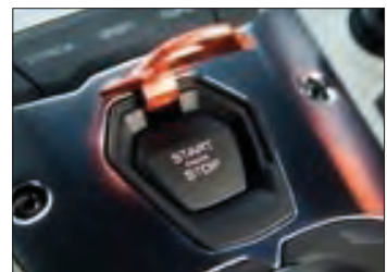
Imagen 108. Parada del motor de coche automático o arranque sin llave
