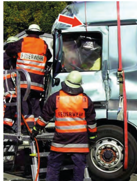
Imagen 329. Aseguramiento de la puerta con cuerda
