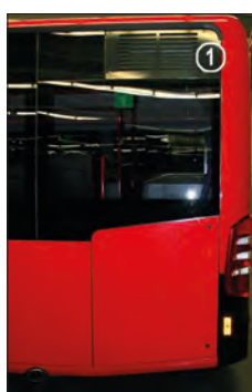
Imagen 112. Entrada de aire al motor en autobuses
