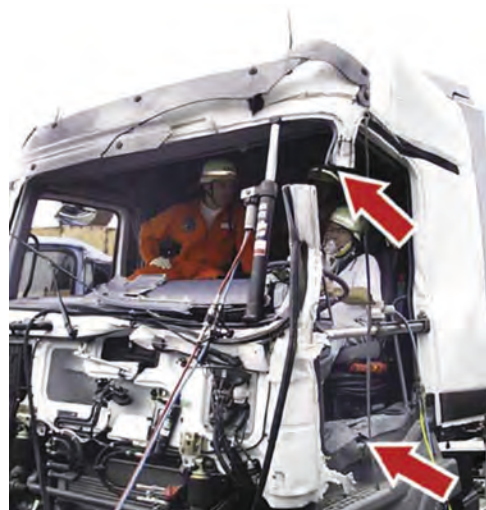
Imagen 341. Cortes de descarga (flechas) y cilindros colocados
