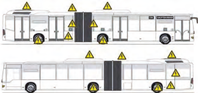
Imagen 180. Componentes y las conducciones del sistema de alta tensión (de 750 V)
