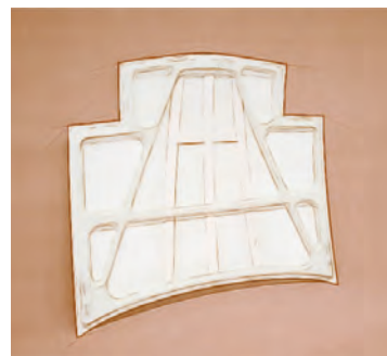
Imagen 61. Refuerzos interiores del capó
