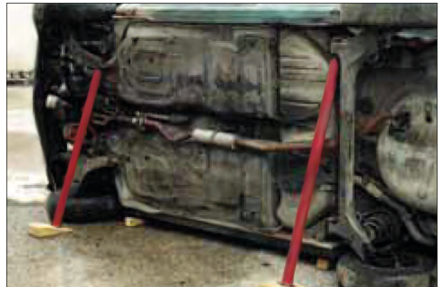
Imagen 151. Puntales mecánicos reforzados con cuñas
