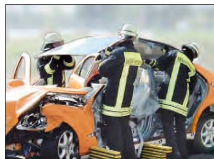
Imagen 256. Retirada del techo
