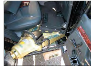
Imagen 215. Colocación del separador en la base de los asientos
