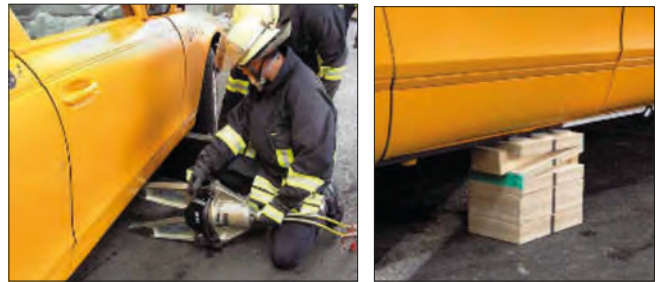
Imagen 146. Vehículo elevado con separador
