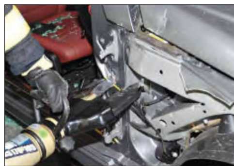
Imagen 295. Corte superior del montante A
