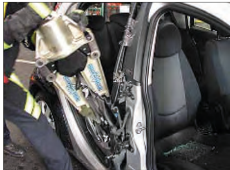
Imagen 313. Aplicación del separador por arriba
