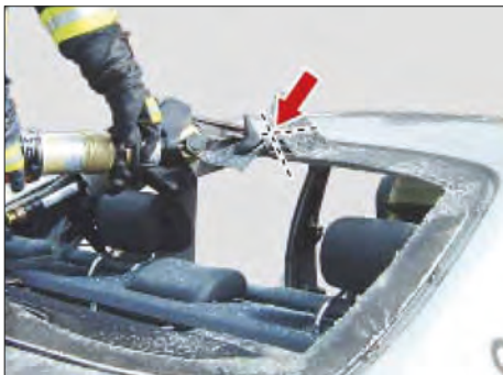
Imagen 265. Corte de descarga en la parte trasera del centro del techo
