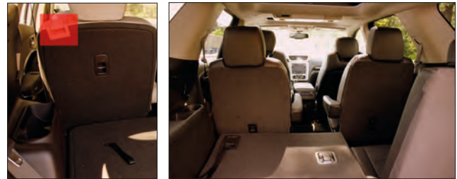
Imagen 234. Sistemas de abatimiento de los asientos traseros
