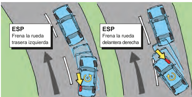
Imagen 52. Funcionamiento del sistema ESP
