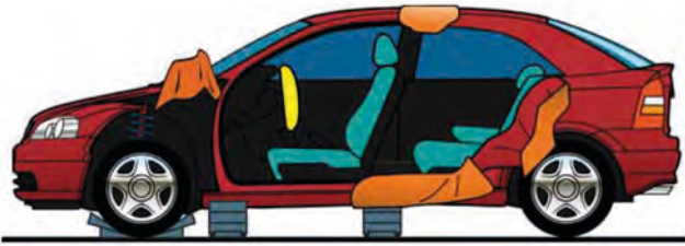
Imagen 219. Creación de una tercera puerta
