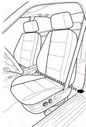
Imagen 236. Lugar de realización del corte de los asientos
