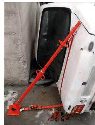
Imagen 169. Estabilización de vehículo de accesibilidad reducida
