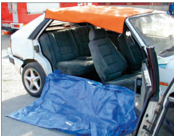
Imagen 99. Protección con lonas
