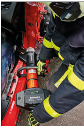
Imagen 214. Corte de alivio del pilar B
