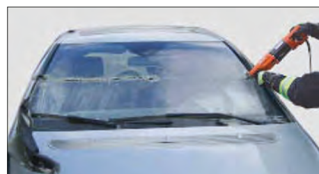
Imagen 250. Corte del parabrisas
