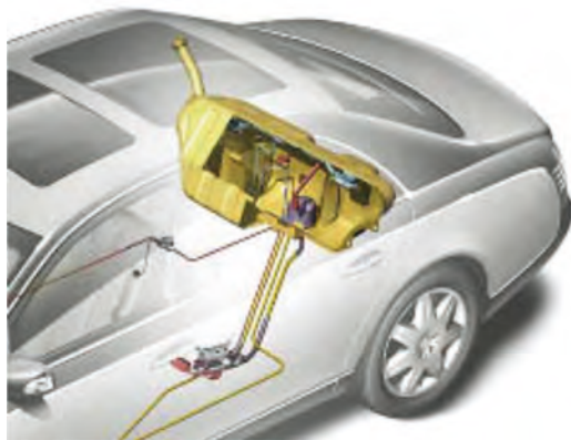
Imagen 67. Emplazamiento de depósito de combustible
