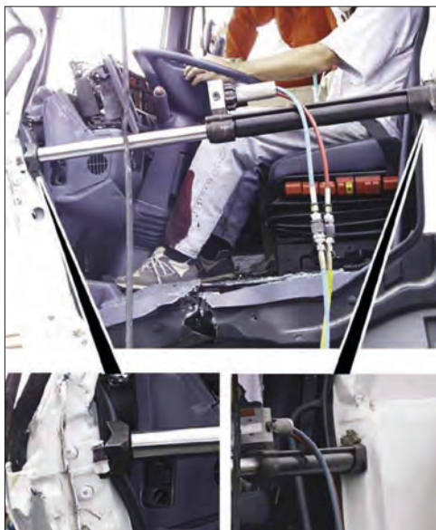
Imagen 338. Instalación del cilindro de rescate
