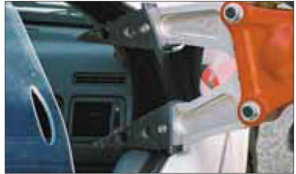
Imagen 198. Apertura de hueco actuando contra el montante A
