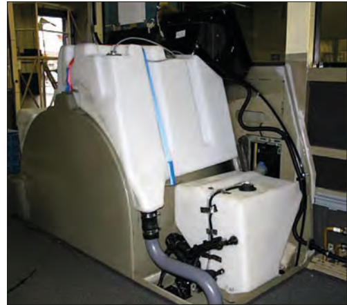
Imagen 344. Autobús urbano. Depósito en el chasis y depósito con superficie de asiento
