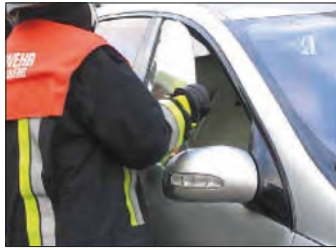
Imagen 185. Extracción del cristal de los rieles de guía
