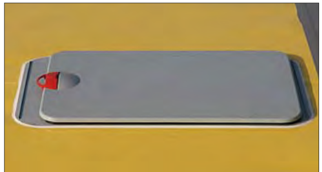
Imagen 360. Apertura de tragaluz desde el exterior
