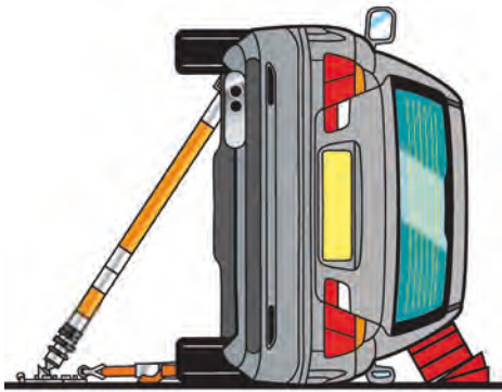
Imagen 148. Estabilización de vehículo sobre su costado
