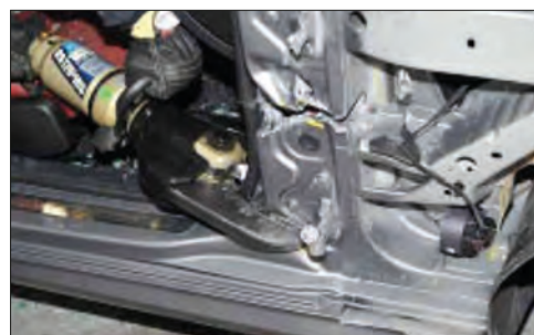
Imagen 296. Corte inferior del montante A
