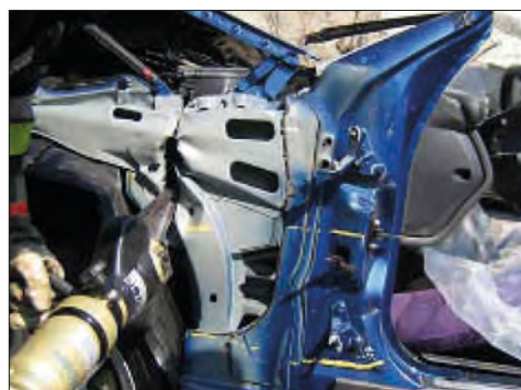
Imagen 288. Corte complementario en la zona del guardabarros
