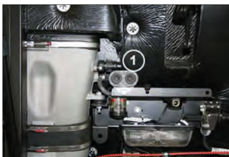
Imagen 110. Pulsador arranque/parada del motor (1) en el compartimento del motor
