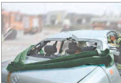
Imagen 140. Colocación de eslingas en vehículo siniestrado
