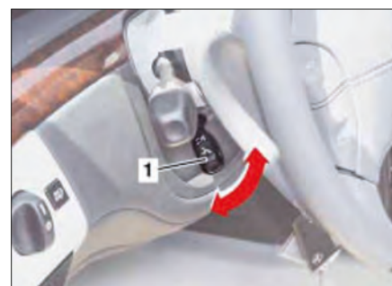
Imagen 240. Interruptor de ayuda entrada/salida
