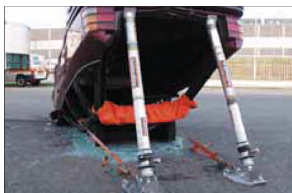
Imagen 275. Apuntalamiento de la parte posterior del vehículo
