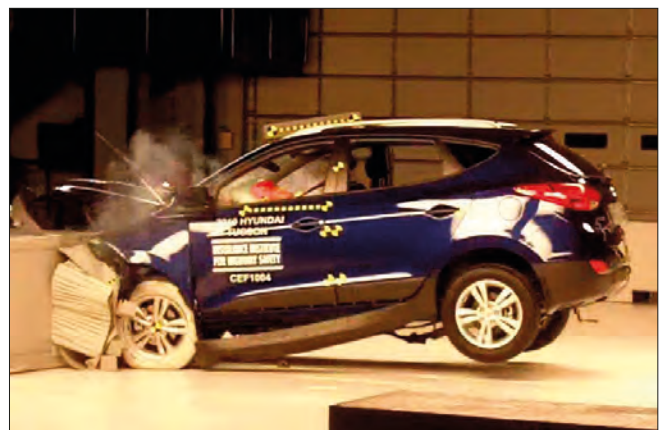
Imagen 2. Transmisión de fuerzas por el diseño estructural en una colisión frontal
