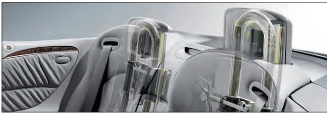
Imagen 64. Arco de seguridad de vehículos descapotables
