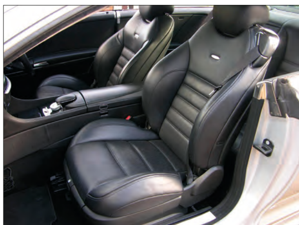
Imagen 79. Sistema de cinturón integrado en el asiento
