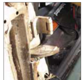
Imagen 304. Realización de cortes de alivio
