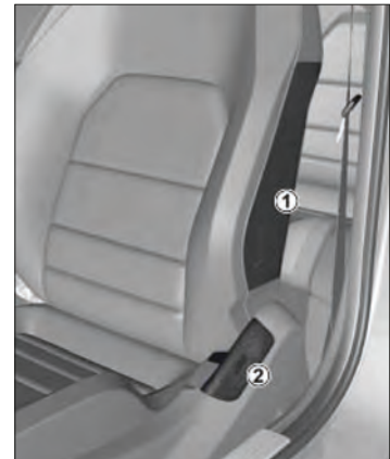
Imagen 177. Airbag lateral de cabeza y tórax (1) y airbag para pelvis (2)
