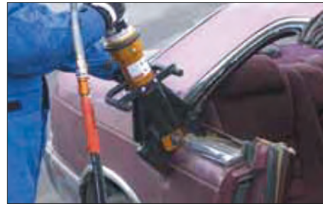
Imagen 223. Corte de alivio en el pilar C
