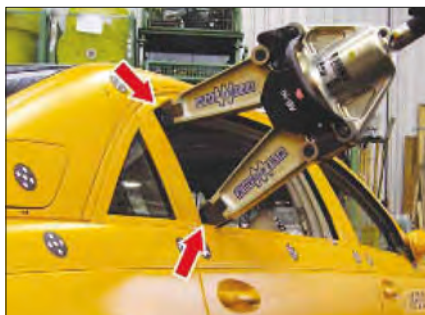
Imagen 201. Colocación del separador para la apertura de puertas traseras
