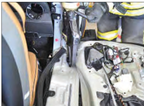
Imagen 208. Corte de la cerradura de la puerta de ala de gaviota
