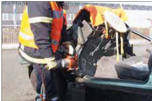
Imagen 300. Levantamiento del salpicadero
