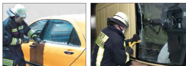
Imagen 184. Forma de cortar los cristales
