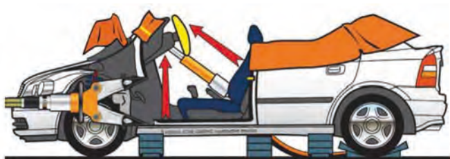
Imagen 293. Levantamiento del salpicadero
