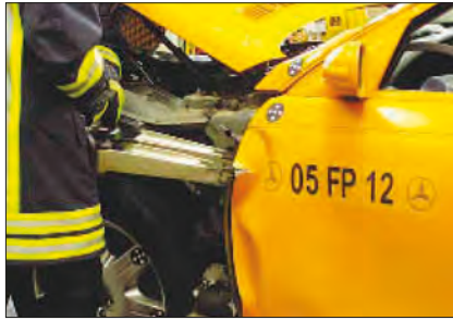
Imagen 200. Apertura de puertas con separador por las bisagras
