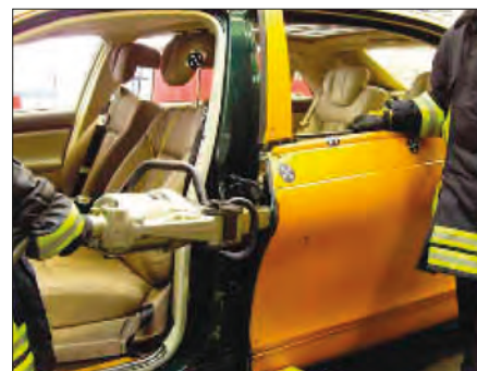
Imagen 211. Apertura de la puerta trasera
