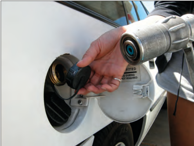
Imagen 34. Tapa de llenado con depósito de gas
