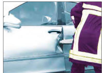
Imagen 188. Apertura de cerradura utilizando separador
