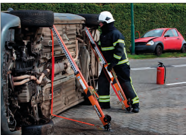
Imagen 149. Utilización de puntales para la estabilización del vehículo
