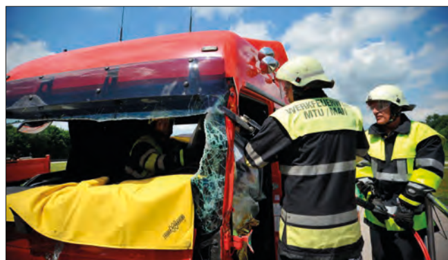
Imagen 335. Primer corte de descarga en el tercio superior de descarga
