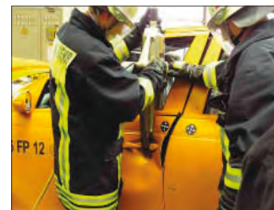
Imagen 189. Maniobra de separación vertical desde arriba
