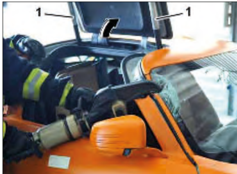
Imagen 206. Muelle de presión de gas (1) de las puertas de ala de gaviota
