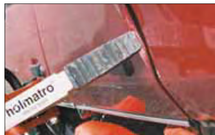
Imagen 231. Realización de abertura a la altura de la cerradura
