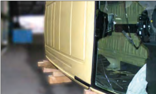
Imagen 154. Estabilización de furgoneta con cuñas
