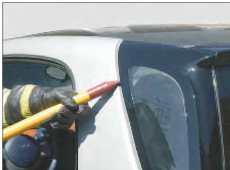
Imagen 186. Extracción de cristales con palanqueta
