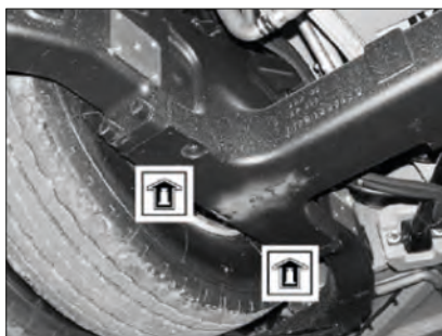
Imagen 164. Ejes (soporte de fuelles neumáticos)
