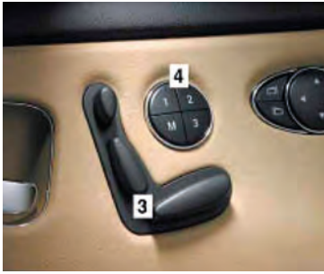
Imagen 241. Panel de mando del asiento y teclas de función de memoria
