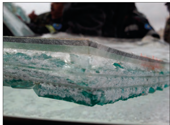
Imagen 346. Cristal de especial protección
