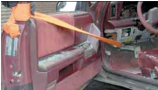
Imagen 306. Uso de cintas o correas para retirar los pedales desde la puerta del conductor
