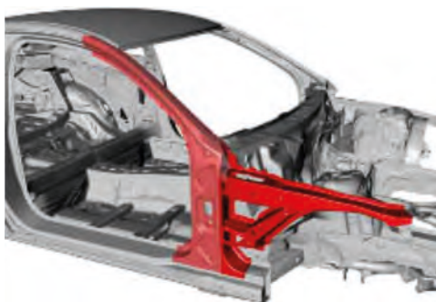
Imagen 294. Refuerzo de montante A y larguero
