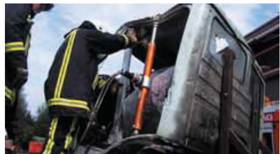
Imagen 330. Uso de cilindro de separación para empujar el techo
