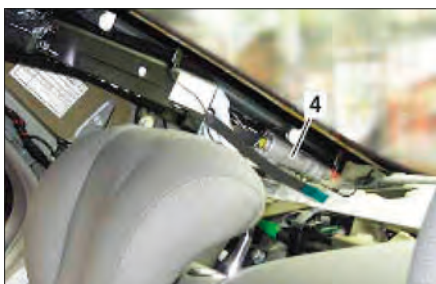
Imagen 254. Generador de gas del montante C (4)
