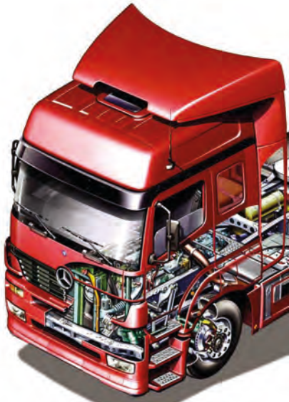
Imagen 320. Estructura de la cabina del camión
