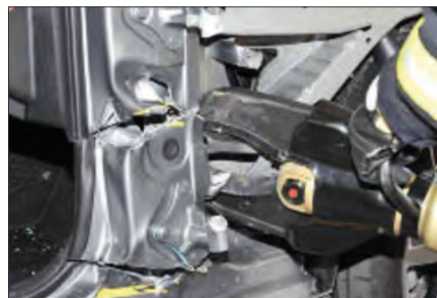
Imagen 297. Corte de descarga en el interior del larguero inferior
