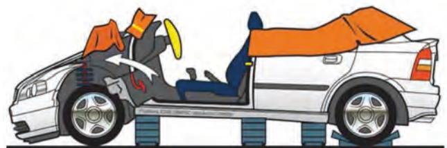
Imagen 303. Liberación del atrapamiento por pedales
