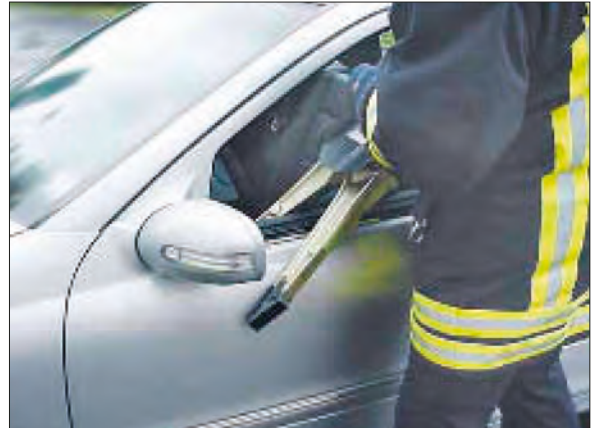
Imagen 199. Apertura de puertas por las bisagras con el separador desde arriba
