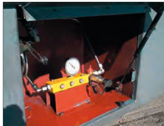
Imagen 135. Válvula de llenado
