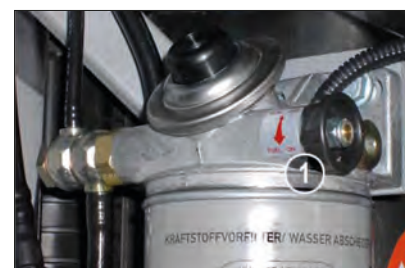
Imagen 116. Cortar el suministro de combustible
