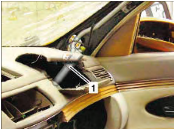
Imagen 245. Generador de gas en el airbag de ventana
