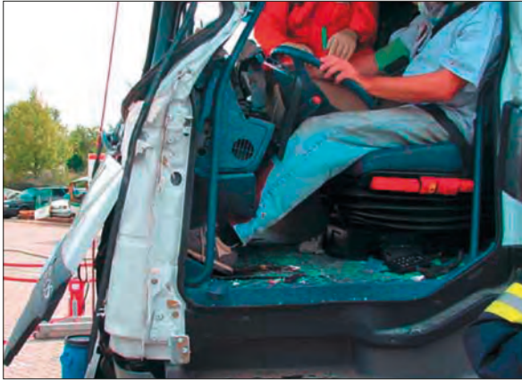
Imagen 327. Punto de colisión por encima de la altura del bastidor
