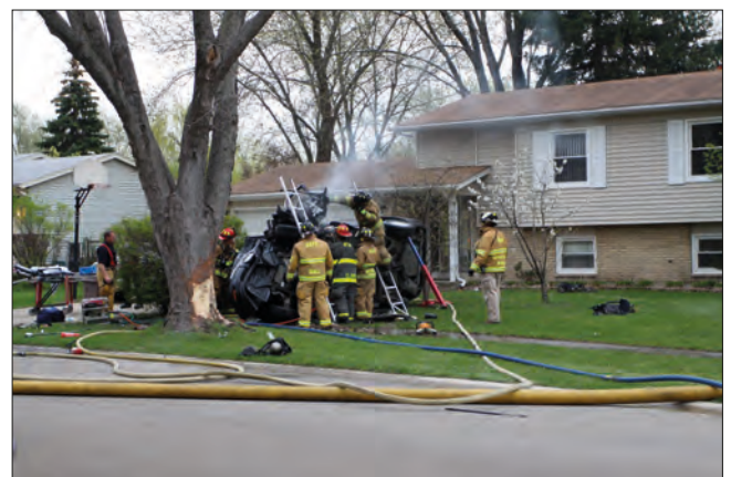
Imagen 152. Estabilización con “medios de fortuna”
