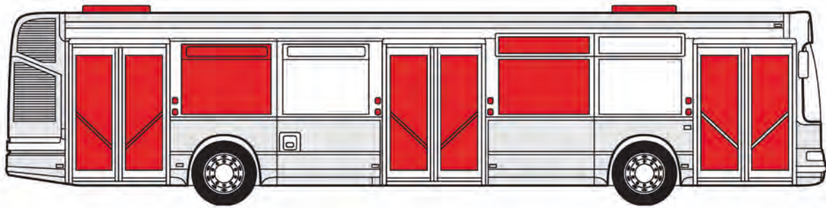
Imagen 345. Detalle de salidas de emergencia de un autobús urbano
