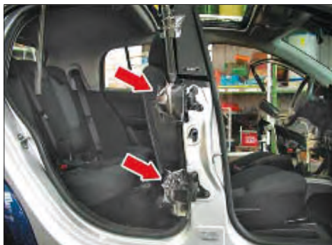
Imagen 314. Recubrimiento de cantos afilados con cubiertas protectoras
