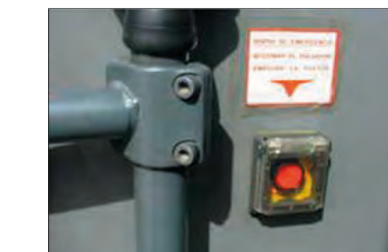
Imagen 352. Llave de emergencia interior. Ejemplo de Autobús urbano
