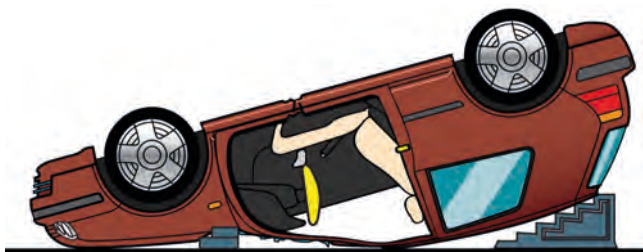
Imagen 226. Retirada de puerta delantera
