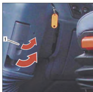
Imagen 333. Desbloqueo manual con seguro mecánico
