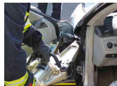
Imagen 195. Retirada de la puerta
