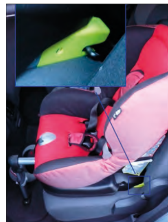
Imagen 73. Sistema Isofix de fijación de sillas infantiles
