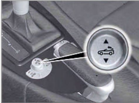
Imagen 258. Interruptor de accionamiento del techo en la consola del techo
