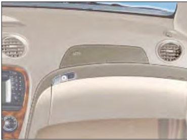
Imagen 173. Airbag del acompañante
