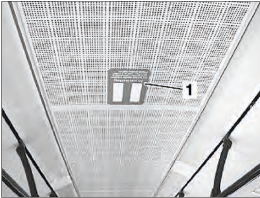
Imagen 355. Ejemplo apertura de trampillas en autobús urbano (1)
