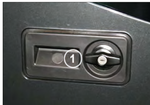
Imagen 349. Pulsador de apertura en autobuses de largo recorrido
