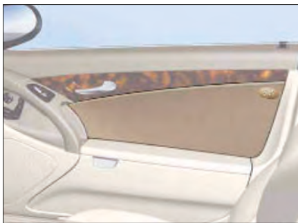
Imagen 174. Airbags laterales delantero en revestimiento de puerta
