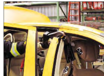
Imagen 217. Corte en el montante B
