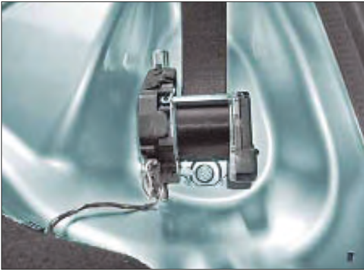
Imagen 82. Pretensores pirotécnicos de tipo tubular acoplado al enrollador
