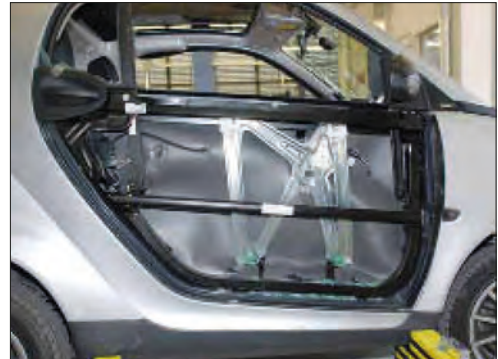
Imagen 308. Puertas de plástico sin revestimiento del Mercedes Smart
