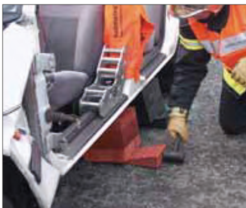
Imagen 285. Colocación de estabilización debajo del pilar B
