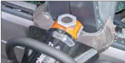
Imagen 251. Corte del montante B por la base
