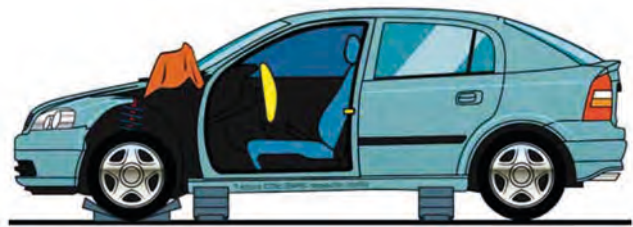
Imagen 187. Apertura/retirada de puertas
