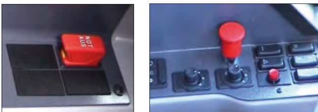
Imagen 117. Interruptor NOT AUS
