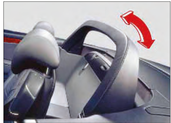
Imagen 70. Arco protector integrado en la estructura
