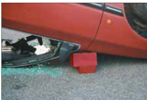
Imagen 159. Uso de bloques adicionales
