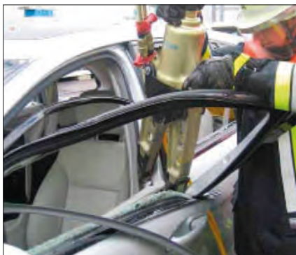
Imagen 192. Cambio en el ángulo de ataque
