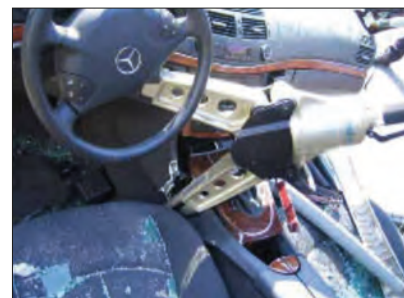
Imagen 302. Presión de la columna de dirección desde el lado del acompañante
