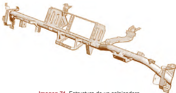
Imagen 71. Estructura de un salpicadero
