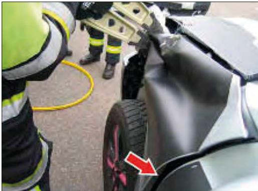
Imagen 197. Retirada de la aleta
