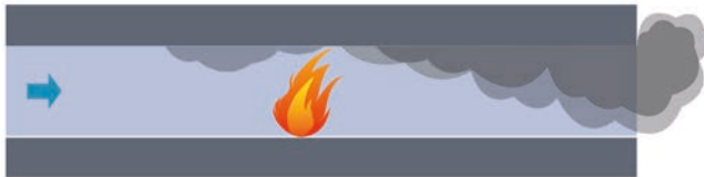
Imagen 7. Progresión del humo en un túnel con un flujo de aire aproximado de 1-3 m/s
