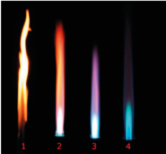
Imagen 176: El color de la llama da información sobre el nivel energético de la misma (azul: mas energético, rojo: menos energético)
