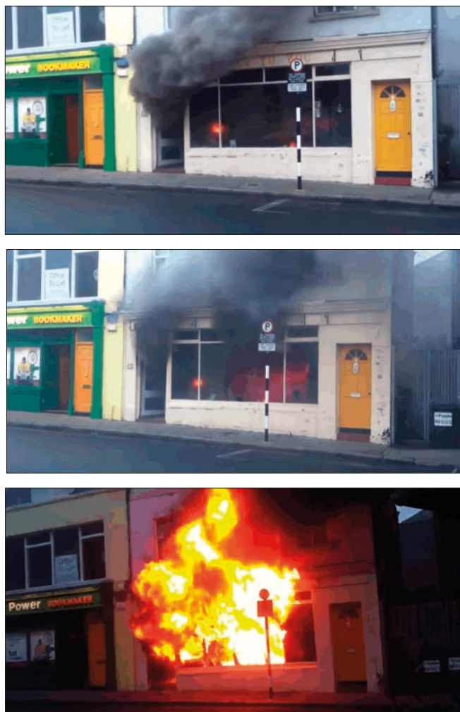
Imagen 30. Incendio en Dalkey Road (Dublín). En la imagen superior se aprecia un incendio infraventilado. A pesar de que la puerta está abierta, el flujo de aire es insuficiente y el incendio no llega a transcurrir por una etapa de flashover . La imagen central reproduce el momento en el que los cristales del escaparate se rompen. Abajo la imagen 1 minuto después en plena etapa de flashover inducido por la ventilación
