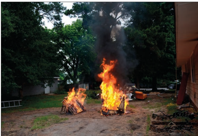
Imagen 32. Comparación de los combustibles modernos ricos en materiales sintéticos y derivados del petróleo con los combustibles tradicionales (madera maciza, fibras textiles vegetales)
