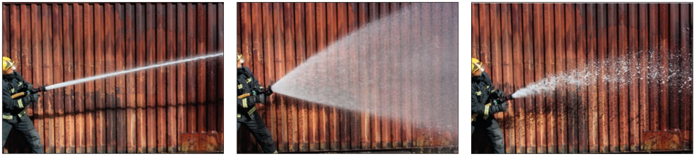
Imagen 44. Secuencia comparativa del tamaño de gota por una lanza de bomberos. La mayor evaporación se va a conseguir con una gota fina propia de un cono de niebla. Chorro sólido o conos de gota gruesa tienen menor eficiencia
