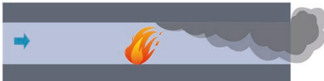
Imagen 8. Progresión del humo en un túnel con un flujo de aire mayor de 3 m/s
