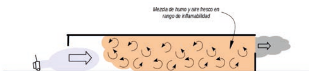
Imagen 124. Ventilación VPP Ofensiva en la que como consecuencia de un tamaño de salida insuficiente, el efecto adverso del viento, pérdidas de carga o ventilador insuficiente, no se produce el barrido sino turbulencias que pueden desplazar la mezcla de gases a rangos de inflamabilidad
