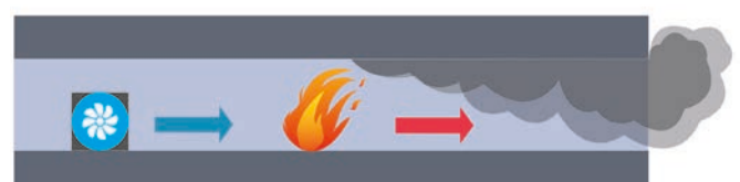
Imagen 15. Desplazamiento de gases dentro del túnel con ventilador
