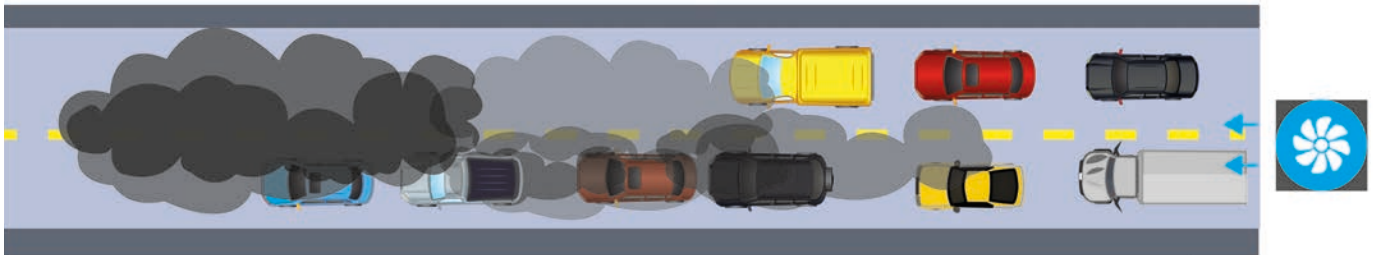
Imagen 28. Incendio y rescate en un túnel de un solo orificio con un coche en llamas después de revertir la dirección del flujo de aire
