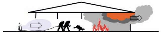
Imagen 123. La Ventilación en Presión Positiva Ofensiva se basa en el barrido de gases de incendio en el recinto en que se encuentra
