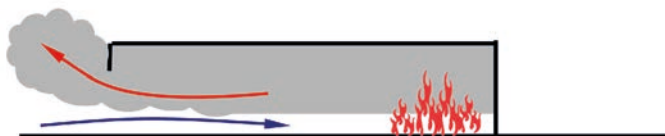
Imagen 49. El flujo de salida, a mayor temperatura, se dilata y requiere una mayor superficie para salir que el de entrada, frío y denso, para entrar
