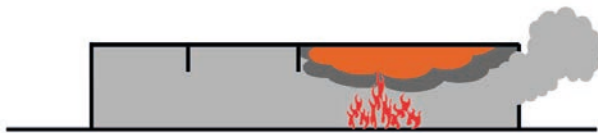
Imagen 6. El incendio de interior se desarrolla en un espacio cerrado que puede tener aperturas al exterior
